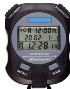
La afirmación I es correcta ya que la lectura indicada llega hasta las centésimas de segundo. La afirmación II es cierta ya que para medir 0,005 s el cronómetro debería apreciar hasta las milésimas de segundo (al menos cinco milésimas de segundo). La afirmación III es incorrecta, debería indicarse 13 min 45,00 s ya que la precisión llega a la centésima de segundo.
